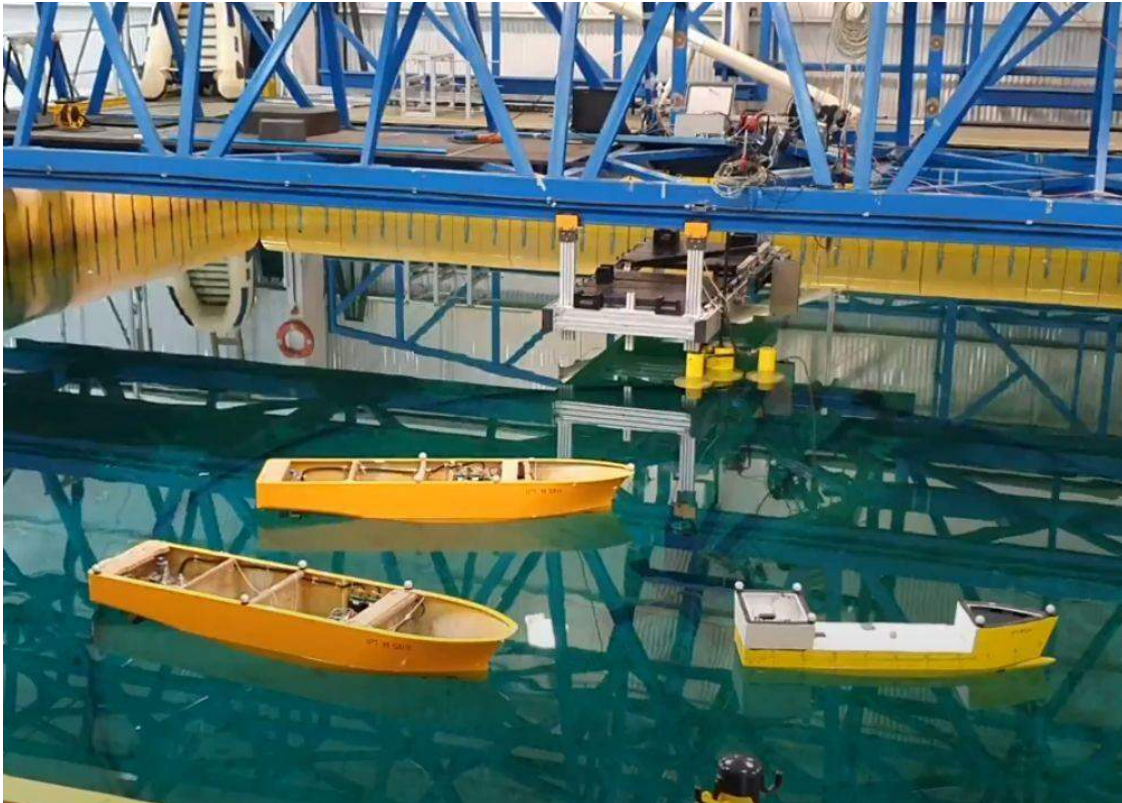
Figura C5. Embarcações DP cooperativas - Tanque de provas (Foto: TPN - USP)
